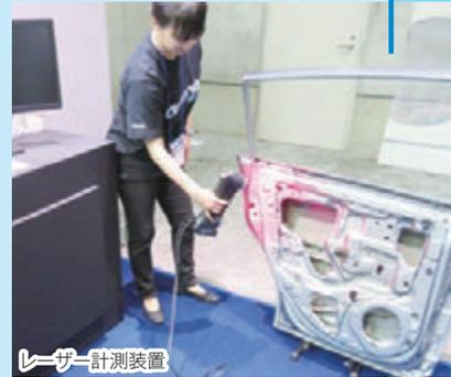
レーザー計測装置
