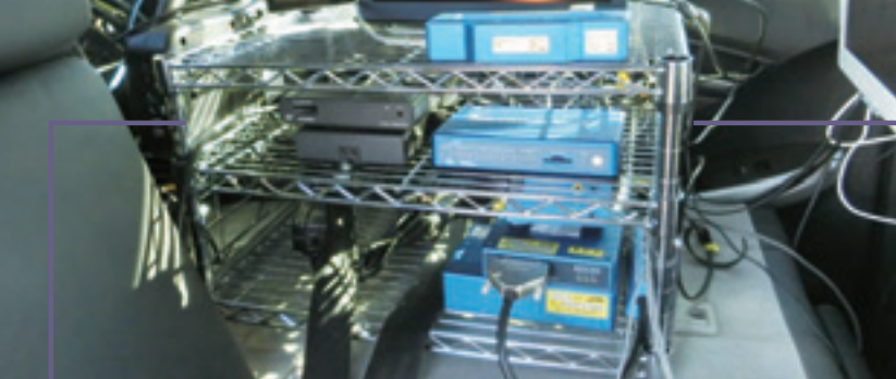
実験車両の後部座席には加速度などを計測するセンサーが搭載されます
