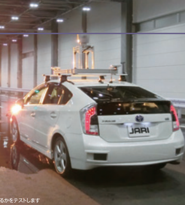
走行の軌道などの測定のために、JARIが用意したカメラを8台取り付けます
