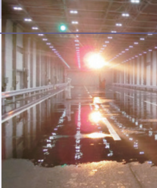
特異環境テストの様子。西日のような逆光の中でもセンサーが検知でき
