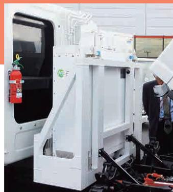
▲いすゞ自動車の交換式バッテリーはキャブと荷台の間に配置。全自動3分で交換作業が完了
