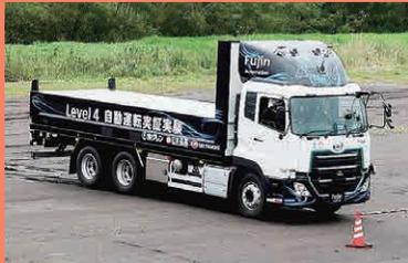
▲UDトラックが大型トラック「クオン」をベース開発する自動運転レベル4の実験車両
