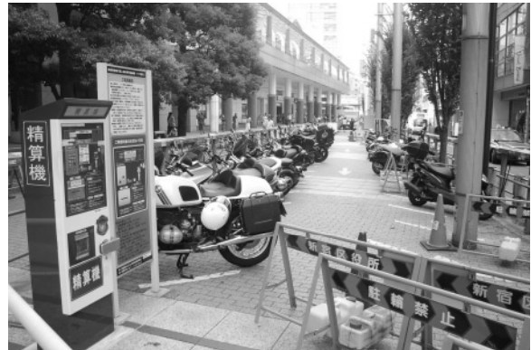
【その他】 駐車した枠の番号を精算機に入力して金額を投入すると、チェーンロックが解除される仕組み。
