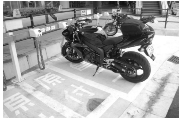
【レイアウト】 駐車枠は、原付(1.9m×0.8m)、自動二輪車(2.3m×1m)。
