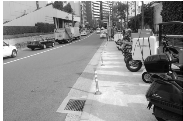
【レイアウト】 駐車枠の後方に 1.4m の場内通路を設けて、安全性、取り回しやすさに配慮した。
