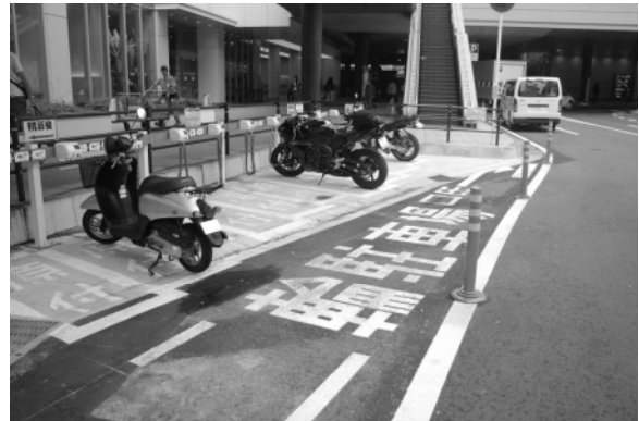
【工夫】 駐車枠の後方に 1.8m の余幅をもたせ、出庫時に方向転換をやすくしている。
