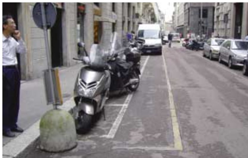
四輪車の駐車スペースを二輪車用に転用した場所。四輪スペースのなごり(ライン)が残っている。
