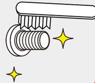
ディスクホイール取付面、ホイールナット当たり面、ハブ取付面(ISO方式では、ハブのはめ合い部も)、ホイールボルト、ナットの錆やゴミ、泥、追加塗装などを取り除きます。
