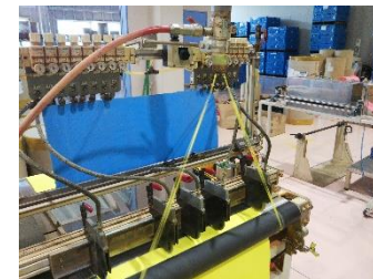
②耳切れ吸い込み状態
