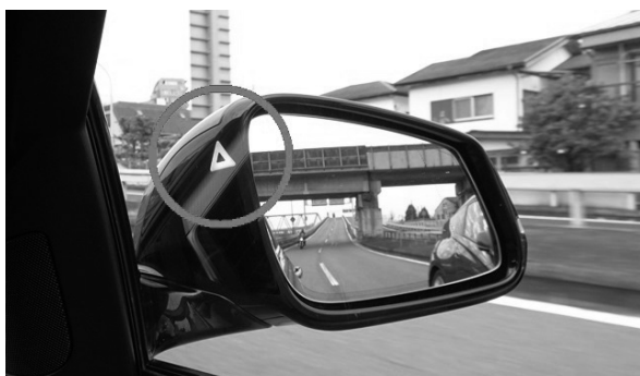
図8●死角にいる車両を示すインジケータ（丸枠内）
