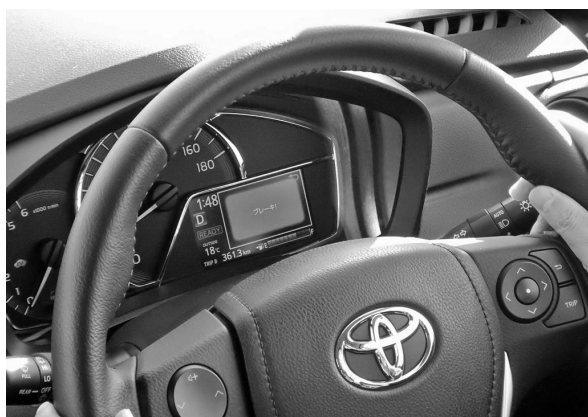
図4●警告時に表示される「ブレーキ!」のディスプレイ
