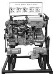
エンジンやステアリング、トランスミッションなどの内部構造を学ぶ教材。実車のパーツを切断して、カット面や重要な部品を着色しており、構造と機能の説明・理解が容易になっている。
