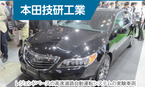
レジェンドベースの高速道路自動運転システムの実験車両
