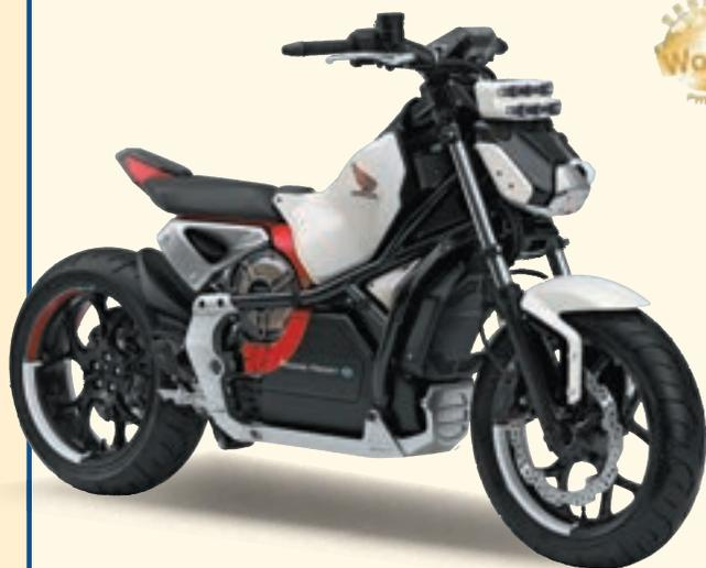
ヒューマノイドロボット研究で培ったHonda独自のバランス制御技術を二輪車に応用。極低速走行時にマシン自体がバランスを保つことで、ライダーの負担を軽減。ライディングを気軽でより楽しいものにします。またパワートレインには電動モーターを採用。Hondaが目指す“自由で楽しい移動の喜び”や“カーボンフリー社会の実現”の具現化に向けた提案です。
