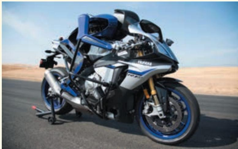
モーターサイクル技術とロボティクス技術を融合し、未知の領域を開拓する自律ライディングロボットです。車両そのものには手を入れず、ヒト側から見た車両操作にフォーカスし、高速でのサーキット走行を可能にしました。2017年の開発マイルストーンとして設定したのは、「200km/h以上でのサーキット走行」と、MotoGPのトップライダー、バレンティーノ・ロッシ選手とのバトル。MOTOBOTの開発で得た高度な要素技術や知見は、既存ビジネスの新たな価値創造や、新規ビジネスの開拓に活かされています。
