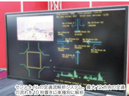
センスタイムの交通流解析システム。最大12方向の交通の流れを10秒置きに車種別に解析
