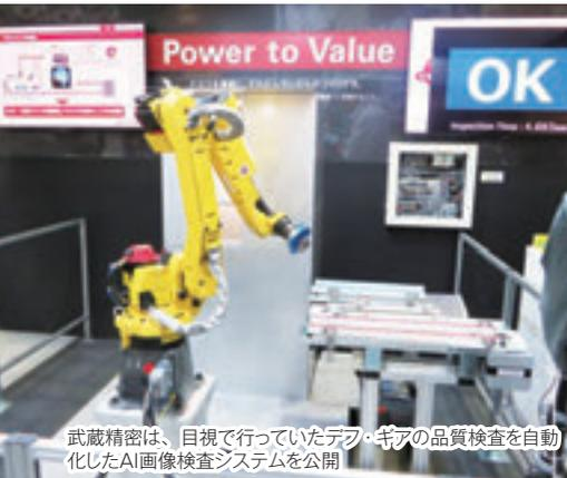
武蔵精密は、目視で行っていたデフ・ギアの品質検査を自動化したAI画像検査システムを公開
