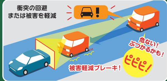
カメラやレーダーが前方の人やクルマを検知して、ぶつかりそうになると警告を発します。さらに衝突の危険があると判断した場合、被害軽減ブレーキをかけます。
