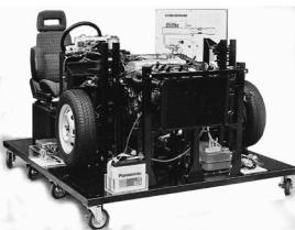
実車のエンジンを使用した教材。実際に始動させたり、分解・組み立てたりして、構造や機能を学習できる。エンジン単体以外に、タイヤや運転席までをセットにしたタイプもある。
