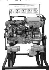
エンジンやステアリング、トランスマッisionなどの内部構造を学ぶ教材。実車のパーツを切断して、カット面や重要な部品を着色してあり、構造と機能の説明・理解が容易になっている。
