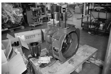
分解されたエンジン。この後、カット→塗装→組み立てという工程をたどる。
