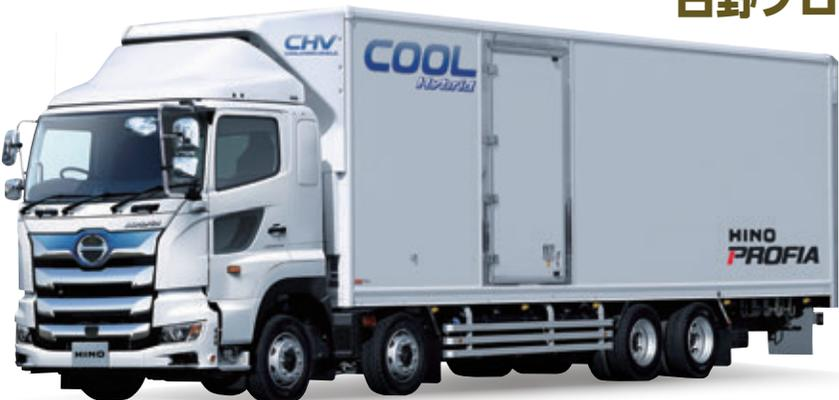
GPSや車載センサー、3D地図情報を元に、100キロ先までの勾配を先読み。AIが走行負荷を予測し、最適なハイブリッド制御を行う世界初の技術を搭載しています。これにより、消費電力の最小化と燃費の最大化を両立し、環境負荷の低減に貢献します。
