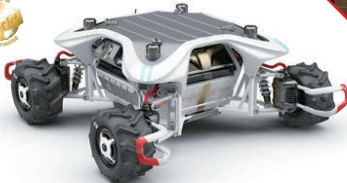
周囲をセンシングしながら大地を自在に移動する自律ソリューションビークル。開発コンセプトは、「呼応し合う・LINK」。AI画像認識により自ら走路を判断。行く先を拒む障害物を検知し、自ら避けて走行します。それぞれ操舵・駆動可能な4つの車輪で方向を問わない移動を実現。高い機動力を備え、人とともに作業するために必要な器用さを持ち合わせています。
