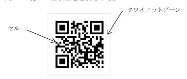
QR コードを用いる場合、プリンタによるセルの太り及び細り、シンボルの歪み、汚れ、擦れなどが生じないように注意が必要である。
