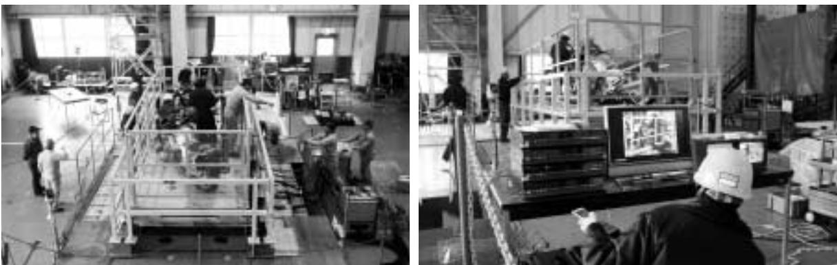
阪神大震災級の地震を再現できる装置に、駐車機器メーカーが開発中の車両固定装置を設置して、二輪車を機械式パレットに駐車（左）。大きな揺れでも倒れない固定方法など、さまざまなデータ採取を行った（右）。
