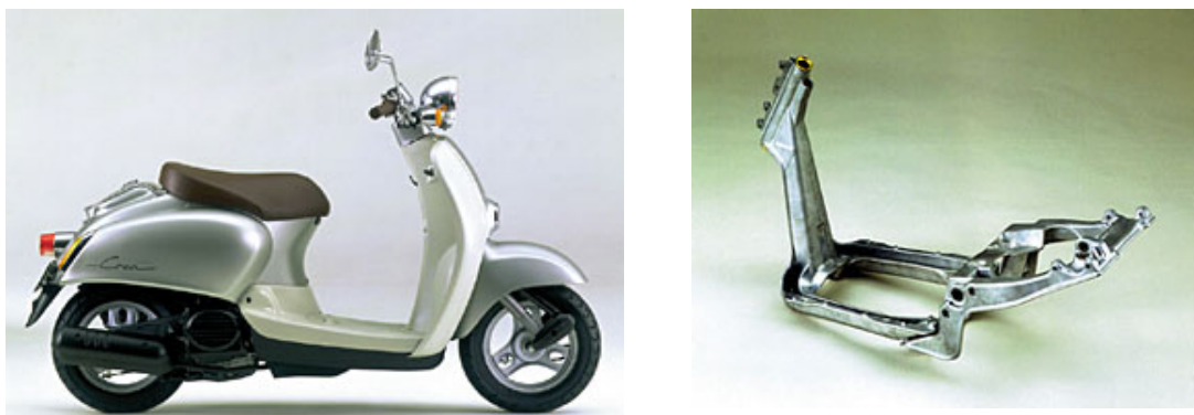
※アルミダイキャストフレームが採用された原付スクーター（左）。軽さと剛性を備えたアルミ製フレーム（右）。
