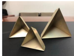
Trihedral Corner Reflector (C/R) ・RCSが既知 ・再帰反射特性
