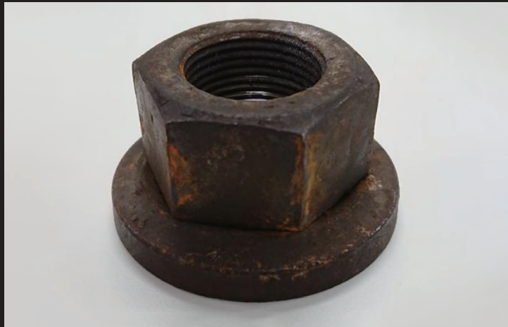
ホイールナットに生じた錆や付着したゴミ等により、ワッシャーの摺動部が固着している。
