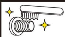
ディスクホイール取付面、ホイールナット当たり面、ハブの取付面、ホイールボルト、ナットの錆やゴミ、追加塗装などを取り除きます。
