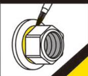
ホイールボルト、ナットのねじ部と、ナットとワッシャーのすき間にエンジンオイルなど指定の潤滑油を薄く塗布し、回転させて油をなじませてください。
